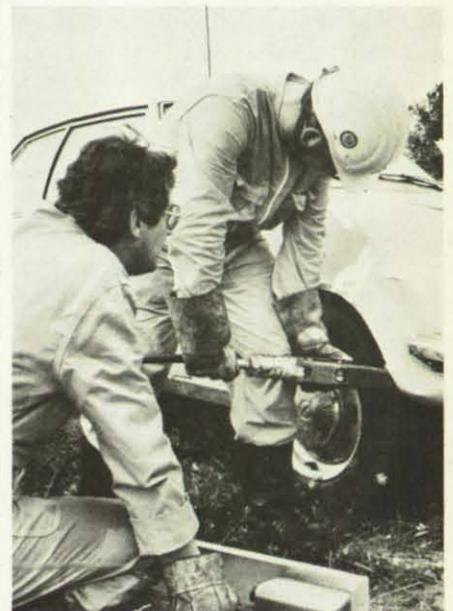
Mit Hilfe des hydraulischen Spreizers wird ein eingedrückter Kotflügel so ausgebeult, daß das Fahrzeug wieder rollen kann.
