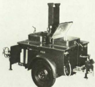
chende Feuerungseinrichtung zugeordnet. Hier stehen zwei Brennersysteme zur Verfügung. Einmal ein Vielstoffbrenner für flüssige Brennstoffe (Benzin, Heizöl, Diesel, Kerosin, Petroleum) mit einer Leistung von 20000 kcal/h. Der Brenner ist als Kompaktbrenner ausgebildet, d. h. der Brennstofftank ist eingebaut. Der Brenner kann ohne Lösen von Schraubverbindungen ausgetauscht werden.
