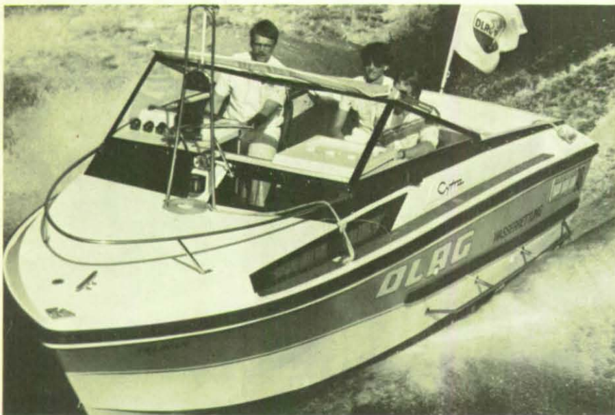
Die „Pelikan“ ist mit einem Achtzylinder-Motor (200 PS) ausgerüstet. Eine Kajüte ermöglicht auch bei schlechtem Wetter optimalen Rettungseinsatz. Das Boot verfügt ferner über einen Bugkorb, einen Mast als Haltepunkt auf dem Vorschiff, eine Bergeplattform am Heck, Feuerlöscheinrichtungen, Rettungsgeräte, Notstromaggregat mit Tauchpumpe und zwei 1000-Watt-Scheinwerfer, drei eingebaute Funkgeräte für DLRG-, Rheinfunk- und BOS-Sprechfunkverkehr. Foto: Peter Fischer
