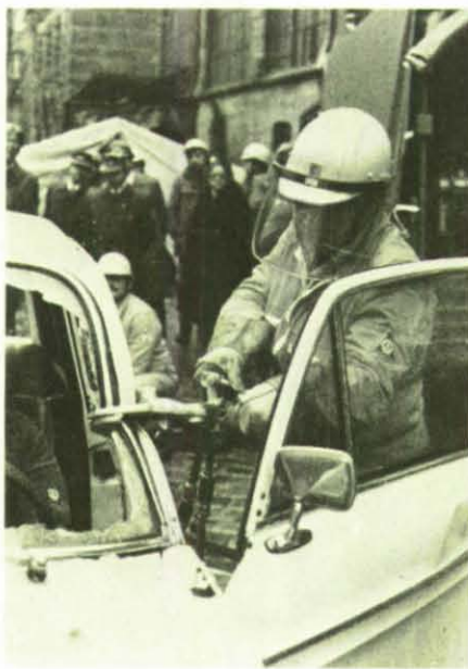
An einem „verunglückten“ Fahrzeug wurde die Leistungsfähigkeit der hydraulischen Rettungsschere demonstriert.
