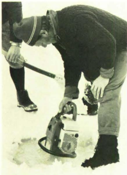
Vorbereitungen zum Eissprengen: Schneiden von Eislöchern mit Hilfe einer Motorsäge ...
