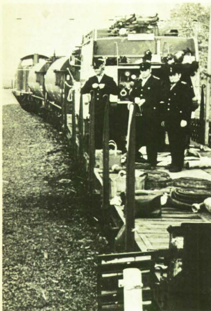
Der kurzfristig zusammengestellte und von einer fahrdrahtunabhängigen Lokomotive gezogene oder geschobene Löschzug, wie er bei der Waldbrandkatastrophe in Niedersachsen vom 10. bis 17. August 1975 zwischen Eschede und Oldendorf bzw. Garßen im Einsatz war: Die beiden Kesselwagen hatten immerhin ein Fassungsvermögen von 40 Tanklöschfahrzeugen. Bei der Bekämpfung des Feuers von der Strecke aus wurden die Kesselwagen auch zur Wasserversorgung anderer Hilfeinheiten eingesetzt.
