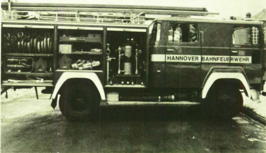
Moderne Löschgruppenfahrzeuge dieses Typs (LF 16/LP) mit einer 250-kg-Löschpulveranlage, eingebauter Motorseilwinde, 800-l-Tank, Schnellangriffseinrichtung, automatischer Feuerlöschkreiselpumpe und zahlreichen technischen Geräten besitzen mehrere Feuerwehren der Deutschen Bundesbahn.
