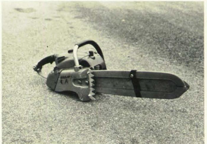
Sicherheitshinweis Nr. 13: Bei der Arbeit mit dem Bergungsmehrzweckgerät ist es verboten, das Gerät mit laufendem Motor zu transportieren (BVS-DV III Nr. 4.4.2.3).
