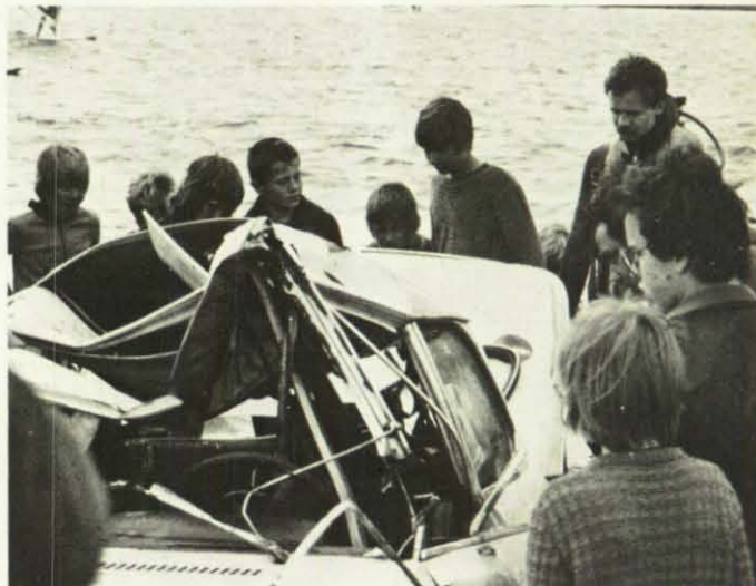
Das Ziehen an der Karosserie führt zu schweren Fahrzeugschäden und zu Ölverschmutzung.
