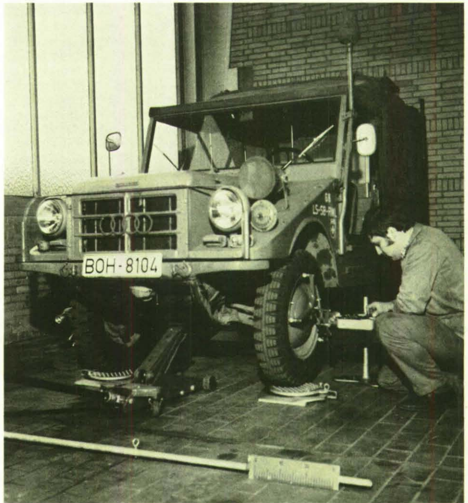
Technische Überprüfung eines Kraftfahrzeuges auf vorzeitige Verschleißerscheinungen u. a.
