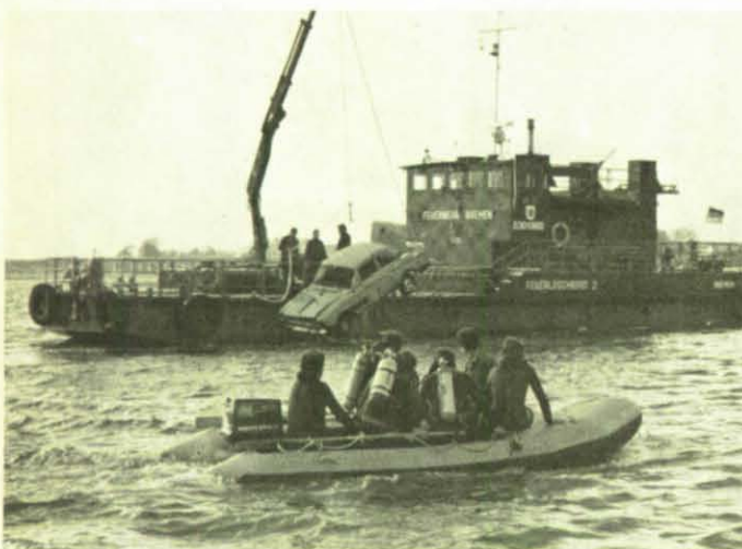
Auch das Bergen von schwimmenden Einheiten aus – wie hier z. B. mit dem Kran des Feuerlöschbootes – ist eine gute Möglichkeit für eine Fahrzeugbergrung, wenn die Taucher in der Lage waren, die Schlepptrasse richtig anzuschlagen.
