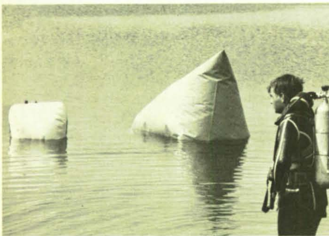
Die Anwendung der Hebesackmethode ist problemlos; das Fahrzeug wird bis unter die Wasseroberfläche aufgetrieben.
