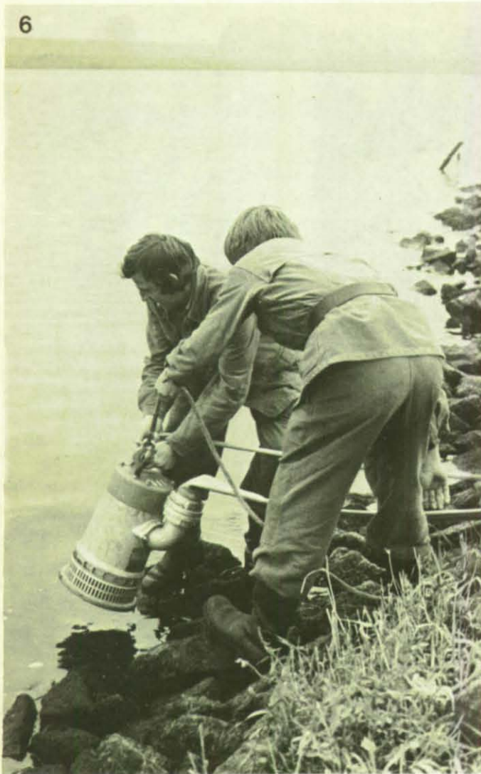
Bild 6: Mit einer Arbeitsleine wird die Elektro-Tauchpumpe ins Wasser abgelassen.
