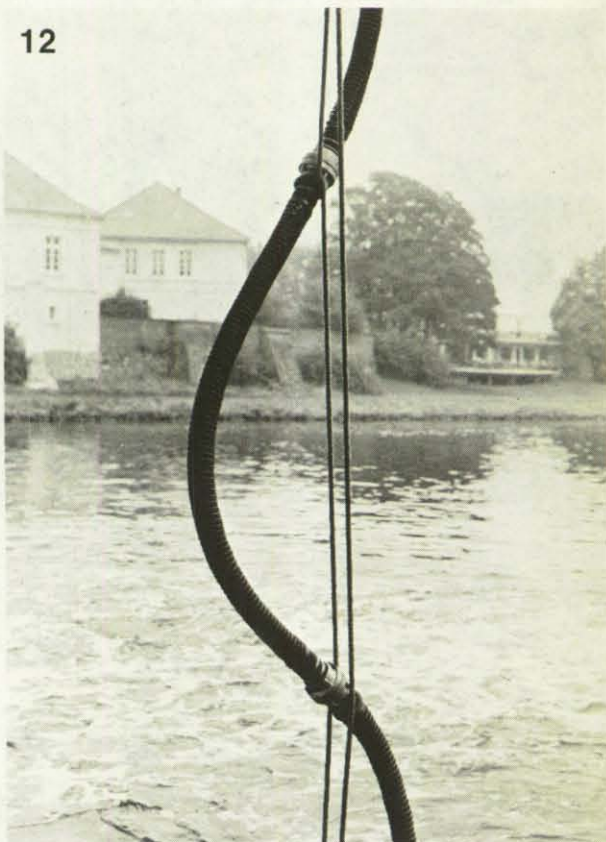
Bild 12: Muß mit Saugschläuchen eine große Höhe überwunden werden, so ist es erforderlich, daß zur Entlastung der Saugkupplungen und -schläuche ein Halbschlag um die untere Kupplung gelegt wird. Mit der zweiten Arbeitsleine kann das Rückschlagventil bedient werden.
