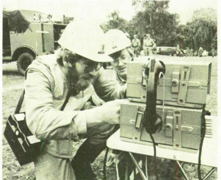
Schwerstarbeit haben die Helfer mit der Rückentrage (Kabelpulgerät) – immerhin ca. 14 kg schwer – zu leisten. Bild rechts: Die Feldvermittlung OB 10 mit Amtsanschleüer wird installiert.
