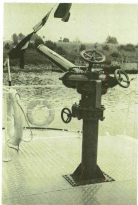
Die „Bewaffung“ des Löschbootes: einer der zwei Monitore, die eine Wurfweite von 45 Metern haben.
