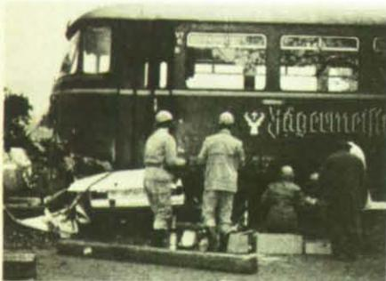
Mit Öldruckhebern hoben die THW-Helfer den Triebwagen an, um das Fahrzeugwrack zu bergen.
