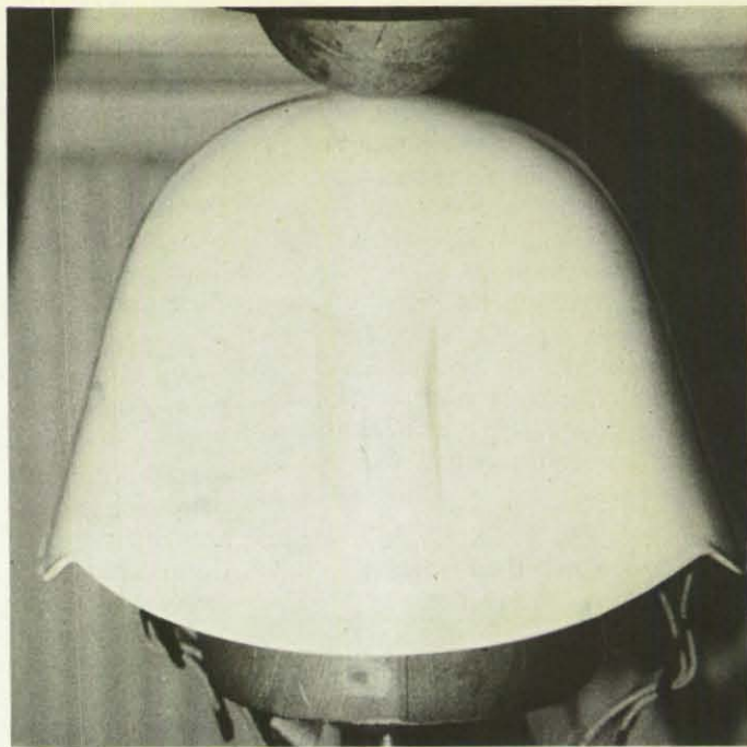
Bild 12: Fallkörperprüfung nach DIN 4840. Bei Aufprall der Kugel wird der auf den Prüfkopf übertragene Kraftverlauf gemessen.
