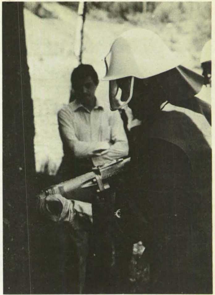
Bild 11: Bei Arbeiten mit dem Schlagbohrhammer hält das Flammschutzgitter Steinsplitter und Staub ab.
