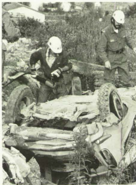
Mit der Rettungsschere trennten die THW-Helfer den Boden des umgestürzten Pkw auf.
