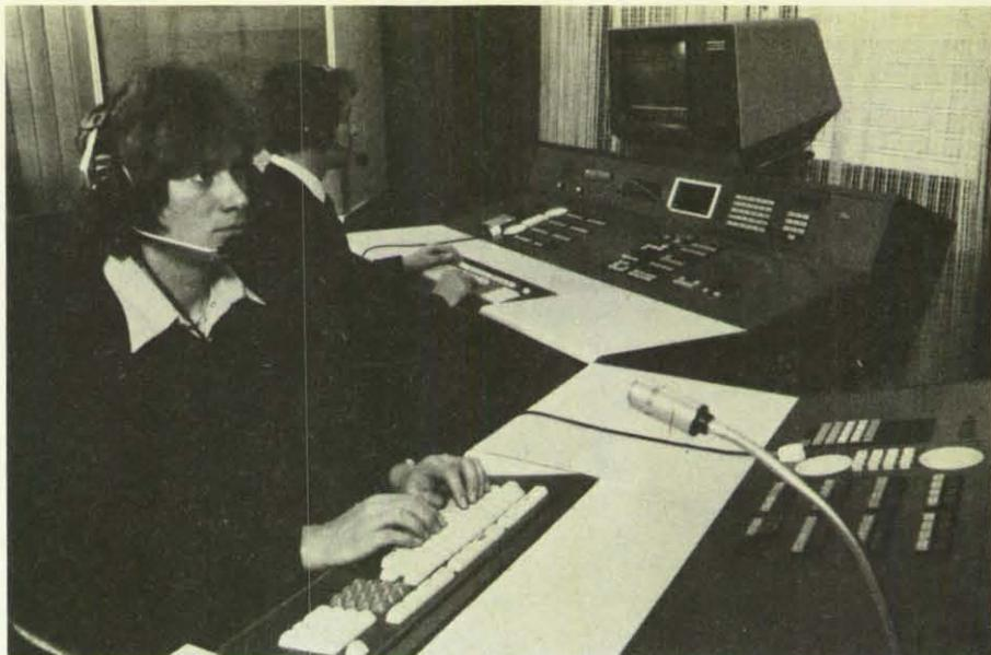
Die in die Funkbedientische integrierten Datenterminals ermöglichen einen optimalen Betriebsablauf. Funk- und Fernsprechabfrage sind Bestandteil des Gesamtsystems.
