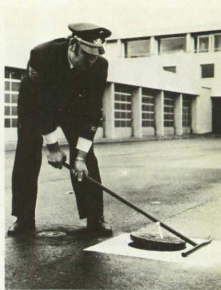
Der verbesserte Unterflurhydrantenschlüssel erleichtert das Öffnen der Hydranten wesentlich und läßt keinen Zeitverzug bei der Löschwasserversorgung auftreten.
