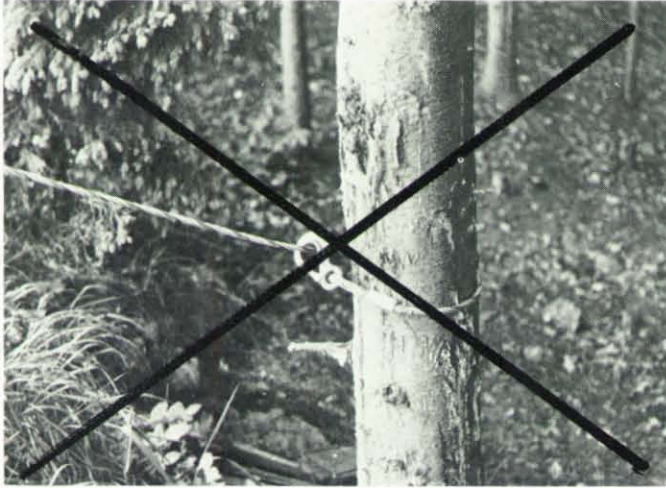
Sicherheitshinweis Nr. 37: Ein direktes Anschlagen des Greifzugseiles an der Last ist verboten (BVS-DV III Nr. 4.4.2.6).
