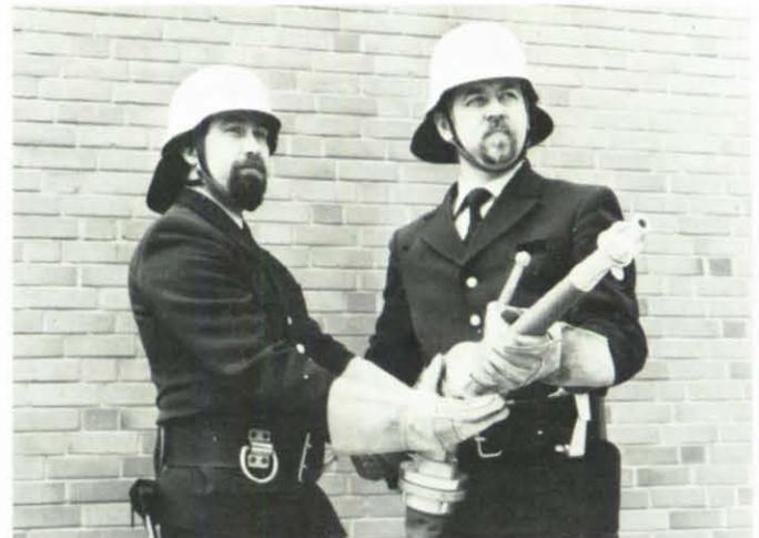
Gefahren durch Strahlrohre werden insbesondere vermieden, wenn . . . bei Verwendung eines Stützkrümmers mindestens 2 Personen das B-Strahlrohr halten. (D zu § 21)
