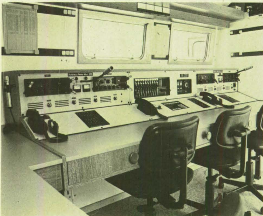
Oben: Die mobile Fernmeldevermittlung „Rotkreuz Rems-Murr 200“, die von den Fellbacher DRK-Helfern selbst geplant und ausgebaut wurde. Unten: Blick auf den Funktisch im Betriebsraum der „rollenden Vermittlung“.
