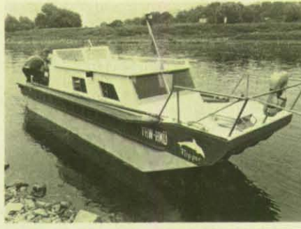
Aus einem ausrangierten Ponton baute die Jugendgruppe ein Kajütboot.
