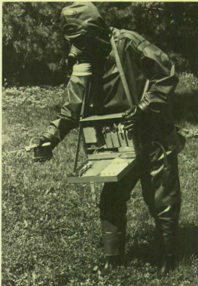
Abb. 5: Spüren von Geländekampfstoffen mittels Prüfröhrchen.
