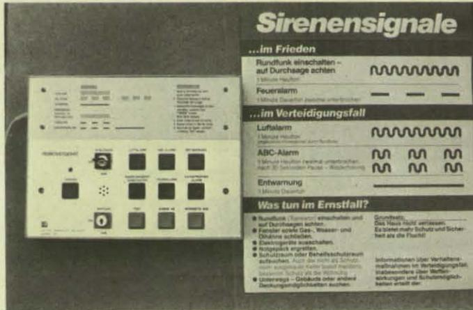
Ein modernes elektronisches Fernastgerä. Die Bedienung erfolgt durch Drucktasten.
