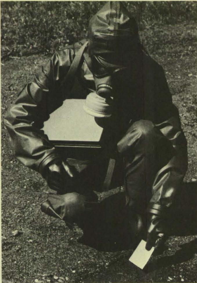
Abb. 6: Spüren von Geländekampfstoffen mittels Spürpapier.
