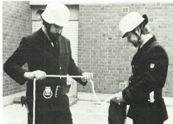
Sicherheitsgurte, Fangleinen, Sprungrettungsgeräte und Leitern sind vor jeder Übung und nach jeder Benutzung einer Sichtprüfung auf Abnutzung und Fehlerstellen zu unterziehen. (§ 26)
