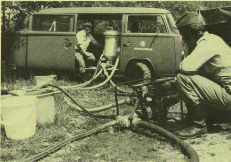
Bild 6: Trinkwasserbereiter TWA 6: VW-Kombi Nr. 1 mit 2 Anschwemmfilter-Kesseln: Vorgang der Grundanschwemmung.
