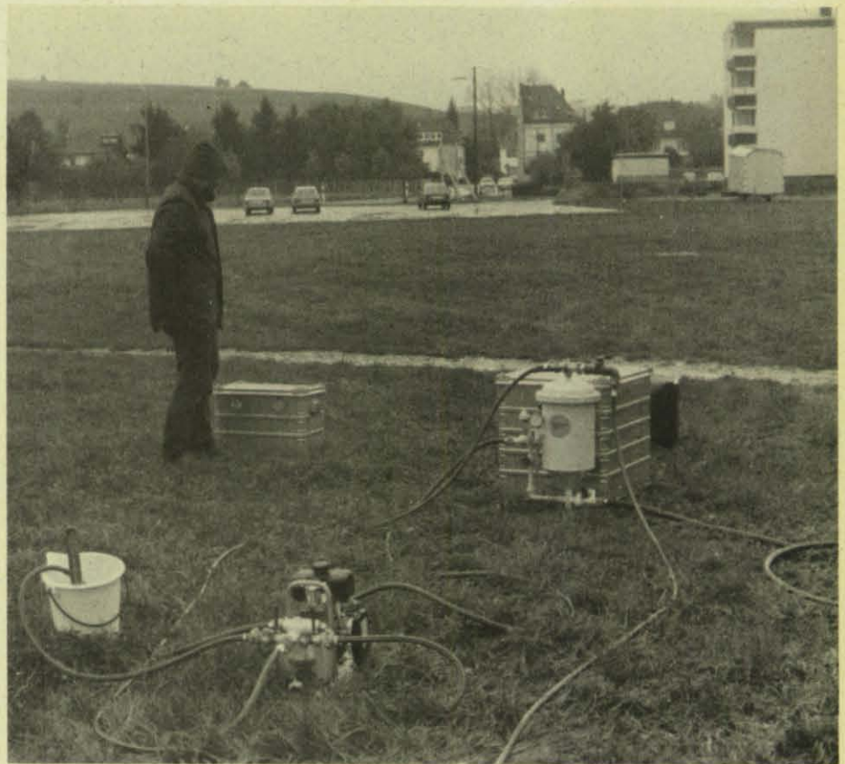
Bild 5: Der Kompaniefilter in betriebsbereiter Aufstellung.
