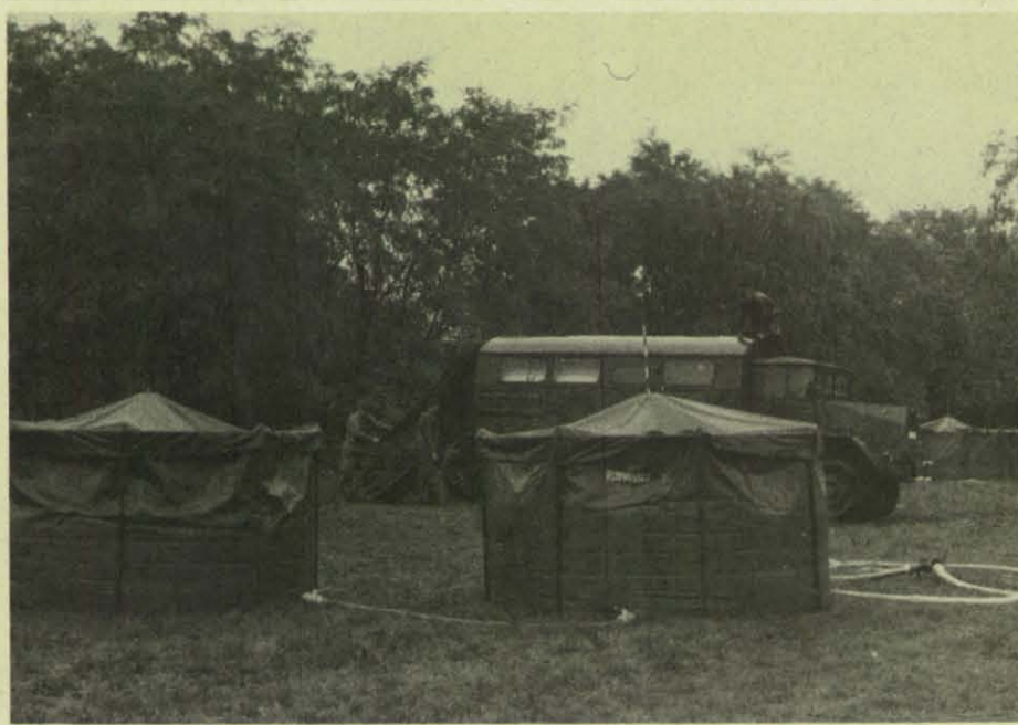
Bild 10: Trinkwasserbereiter TWA 10: Anlage mit Lastkraftwagen und aufgestellten flexiblen Behältern für Rein- und Rohwasser.
