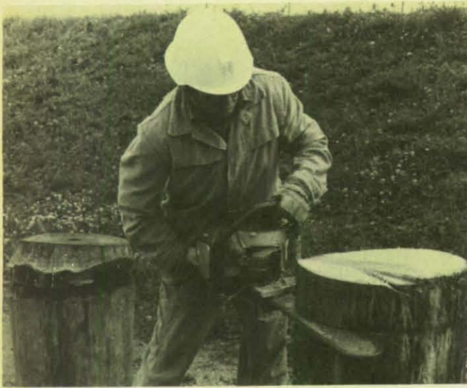
Das Teilgebiet 6 der Grundausbildung beinhaltet u. a. den Umgang mit der Motorsäge. Als Prüfungsaufgabe wird das Herstellen der Fallkerbsohle demonstriert.
