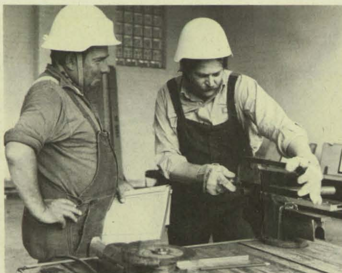
Durchtrennen eines Metallrohres mit der Metallsäge: Der Prüfer bewertet die Ausführung der Aufgabe auch hinsichtlich der Arbeitssicherheit (Tragen von Schutzhandschuhen).
