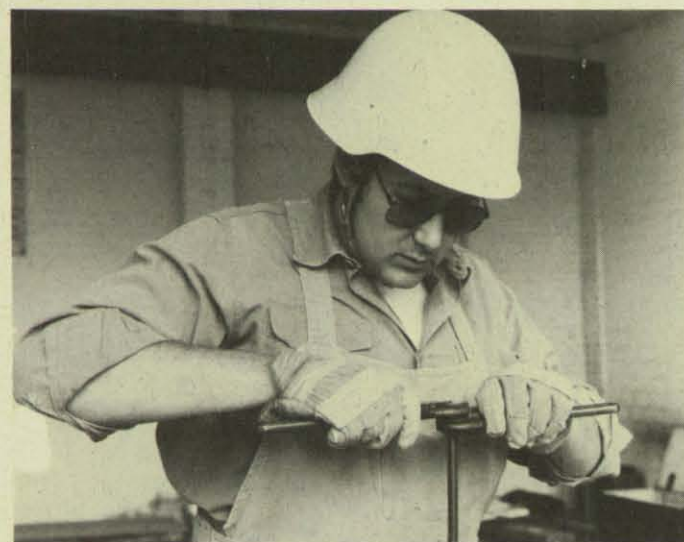
Im Teilgebiet Metallbearbeitung ist als Prüfungsaufgabe eine Schraubenverbindung mit Hilfe von Rohrzanzen-Einhändern zu lösen.
