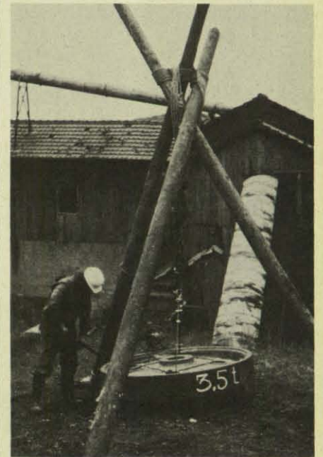
Eine der Aufgaben im Fachlehrgang ist das Erstellen eines Dreibecks zum Heben schwerer Lasten.
