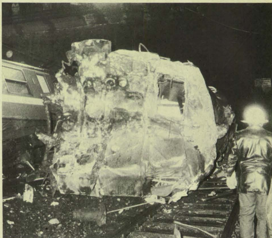
Die schwere E-Lok wurde durch den Aufprall völlig deformiert.
