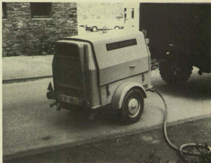
Bild 7b (unten): Fahrbarer Baukompressor, schalldämmend, zum Betrieb des Lufthebebrunnens.
