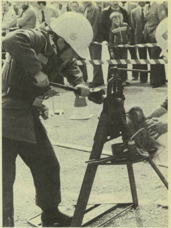
Bild links: Beim Wettkampf des I-Dienstes: Hier wird an einer Freileitung 0,4 kV unter Einhaltung der Sicherheitsvorschriften gearbeitet. Die Leitung ist freigeschaltet, geerdet und kurzgeschlossen. Ein Kabelanschluß wird vorbereitet. Bild rechts: Gewindeschneiden an einem Stahlrohr 1".
