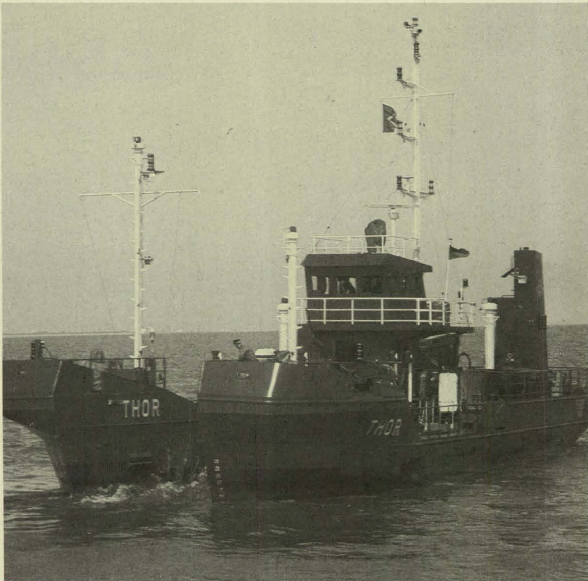
Der Prototyp eines Offshore-Ölabsauggerätes, das den Ölteppich aufsaugt, den die von zwei Schleppern gezogene Ölsperre staut. (Skizze: Krupp)
