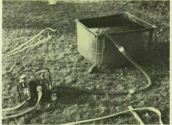
Der Wasserbehälter, gefüllt mit 3000 Litern, steht bereit, die Schläuche sind an die Tragkraftspritze angeschlossen.
