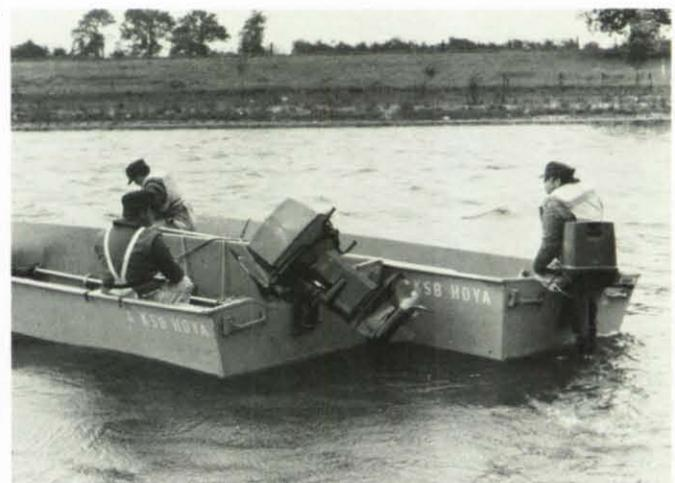
Um die Manövrierfähigkeit zu erhalten, muß das Heck des schleppenden Fahrzeuges etwa ein Drittel über dem des geschleppten Fahrzeuges hinausragen (KatS DV 282, Seite 83).
