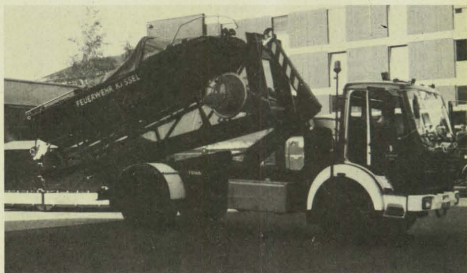
Wechsellader-Fahrzeug mit Abrollbehälter „Boot“ und Einmann-Taucherdruckkammer.
