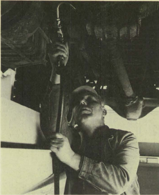
Von der Schmierdienstgrube aus wird neues Getriebeöl eingefüllt.
