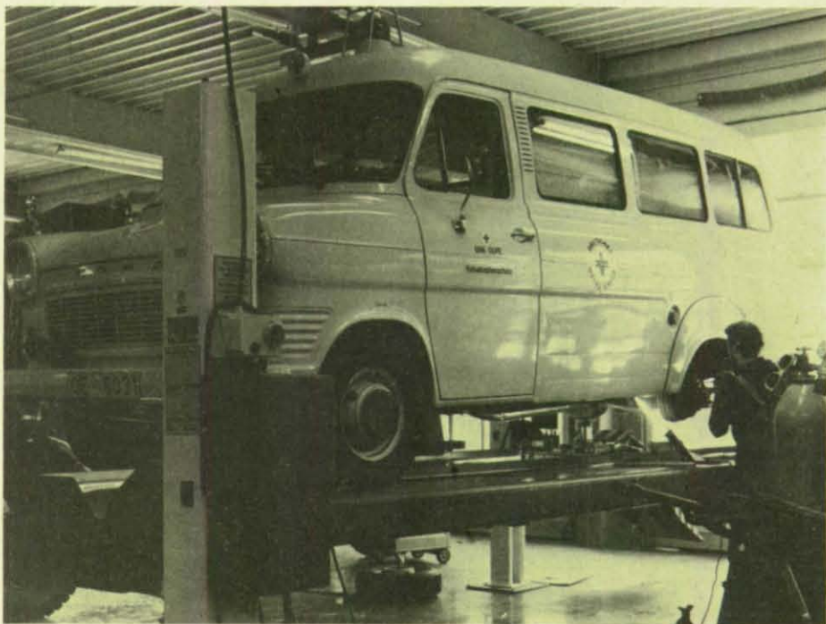
Vier feste Hebebühnen erleichtern den Mechanikern die Arbeit an den Einsatzfahrzeugen.
