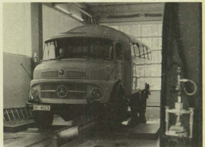
Ein Einsatzfahrzeug des DRK auf dem Bremsrollen-Prüfstand.
