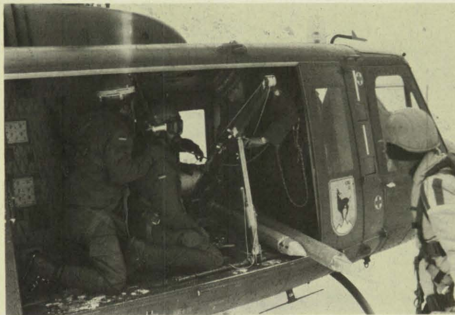
Der Absenkgalgen wird nochmals überprüft.
