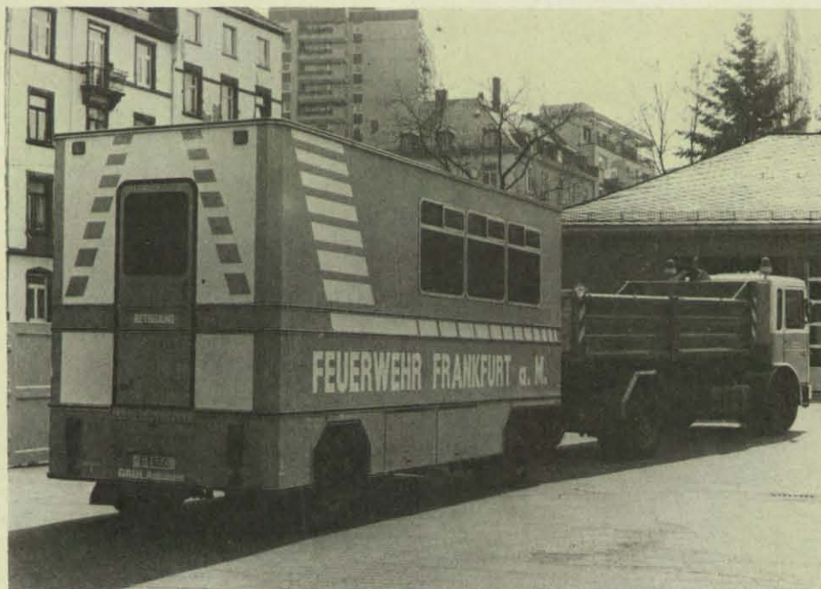
Auf eigenen Antrieb und Geländegängigkeit wurde verzichtet. Bei einem Einsatz werden die Anhänger durch vorhandene Zugfahrzeuge an die Schadensstelle transportiert.
