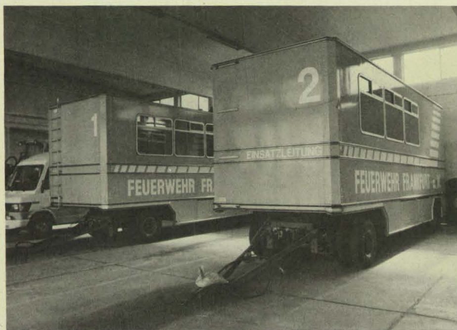
Die nach einheitlichem System gestalteten Aufbauten können an Einsatzstellen je nach Bedarf leicht zu größeren Einheiten miteinander verbunden werden.
