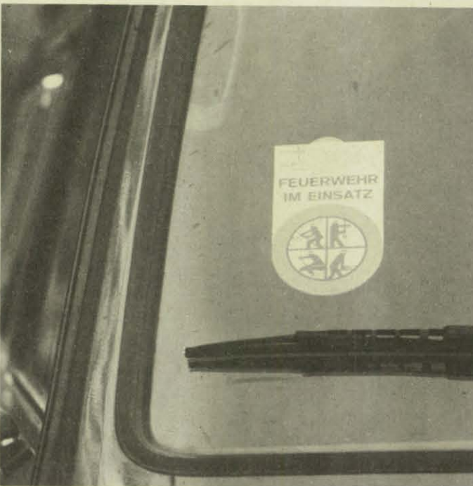
Das Kennzeichnungsschild wird mittels eines Saugknopfes an der Windschutz- oder Seitenscheibe befestigt.
