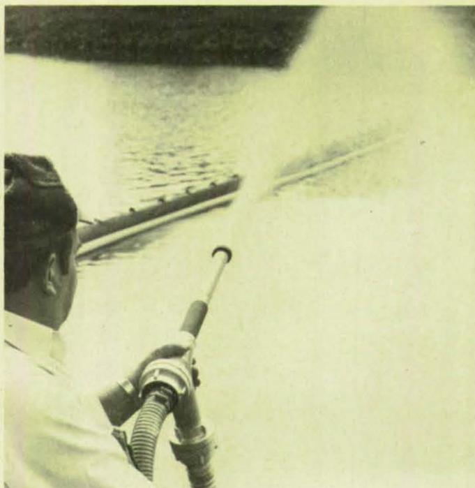
**Zum Ausbringen von Ölbindemitteln (Granulat) findet ein Injektionsstrahlrohr Verwendung. Entsprechend der verwendeten Pumpe können Wurfwei-ten bis 30 m erzielt werden.**
