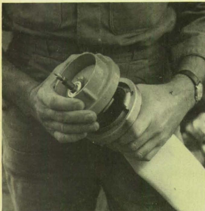
**B-Druckschläuche werden mit Blindkupplungen, auf welchen handelsübliche Reifenfüllventile angebracht wurden, verschlossen und können, nachdem sie aufgepumpt wurden, als behelfsmäßige Ölsperren verwendet werden. Sie eignen sich insbesondere zum Einschlingeln vagabundierender Öllachen auf stehenden Gewässern und zur Uferabsicherung.**
