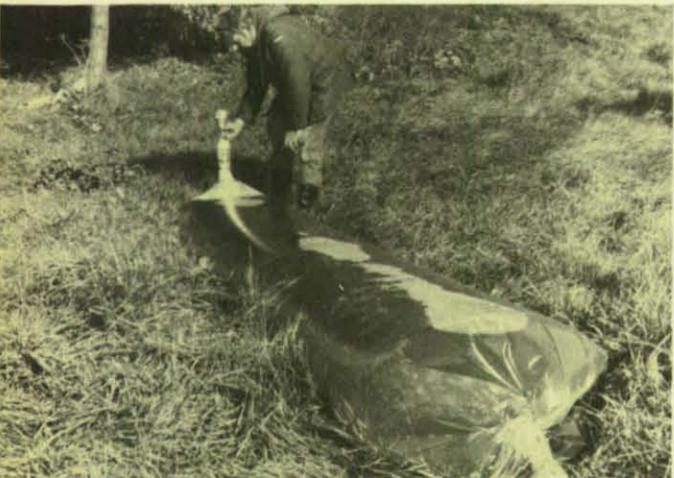
Zur Zwischenlagerung von Flüssigkeiten findet „Einwegschlauchfolie“ Verwendung. Diese ist als Endlosfolie in 100-m-Rollen bei den AÖ-Gruppen vorhanden. Für den Einsatz werden entsprechende Längen abgeschnitten, an beiden Enden unter Verwendung von Schlauchschellen-Kupplungen eingehend und mit Hilfe von Pumpen befüllt.
