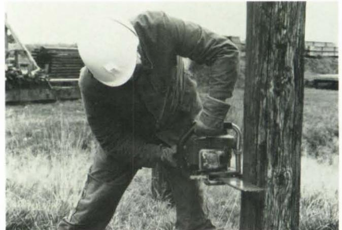
Beim Ablängen eines Stammes von oben nach unten und von unten nach oben ist der Krallenanschlag fest anzusetzen. Er dient beim Sägen als Hebelarm.
