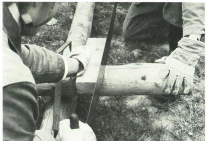
Das richtige Ansetzen der Schrot- und Bügelsäge erfolgt mit einem Führungsholz am Riss.
