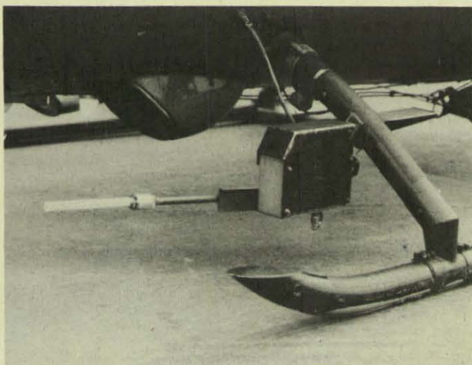
An der Seitenstrebe des Hubschraubers ist die Sendeantenne untergebracht.
