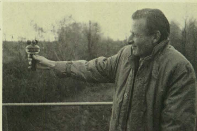
Mit dem Handwindmeßgerät läßt sich die Windgeschwindigkeit feststellen. (Fotos: Schulz)
