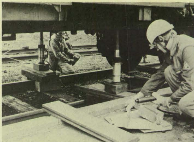
Besondere Sorgfalt erfordert der Umgang mit der Hydropresse beim Aufgleisen eines Waggons. (Foto: Riechelmann)
