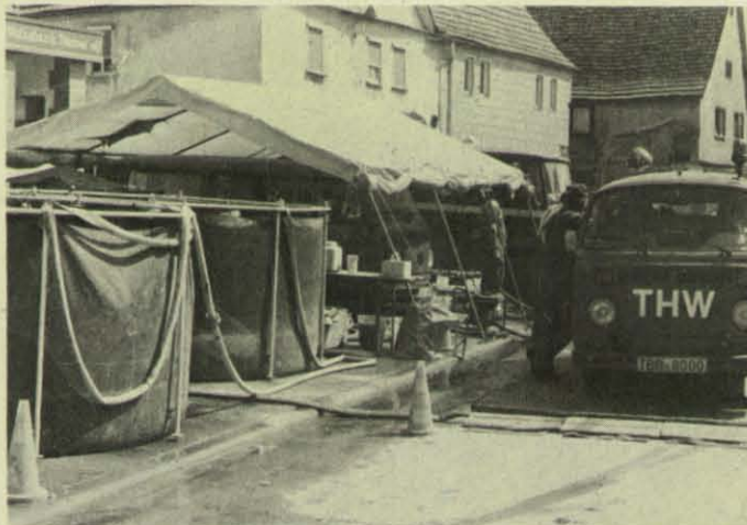
Mit der Trinkwasseraufbereitungsanlage „Berkefeld“ wird Königheim acht Tage lang mit Wasser aus dem Dorfbach versorgt.
