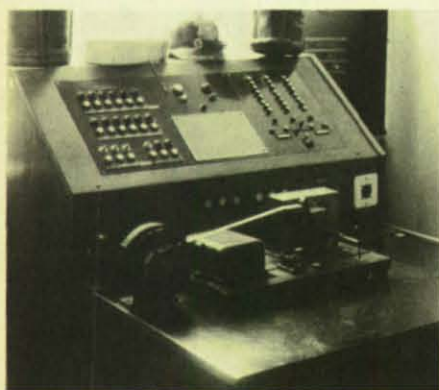
Ausgetüftelte Technik: Ein Morsegerät zum Alarmieren der Feuerwehr.
