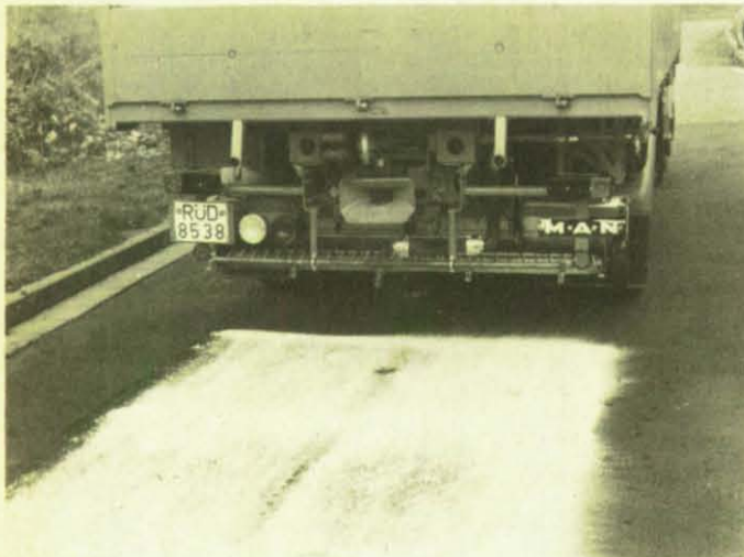
Ausbringen von Entgiftungsstoff mit der Streuanlage in Verbindung mit der Wassersprühvorrichtung.
