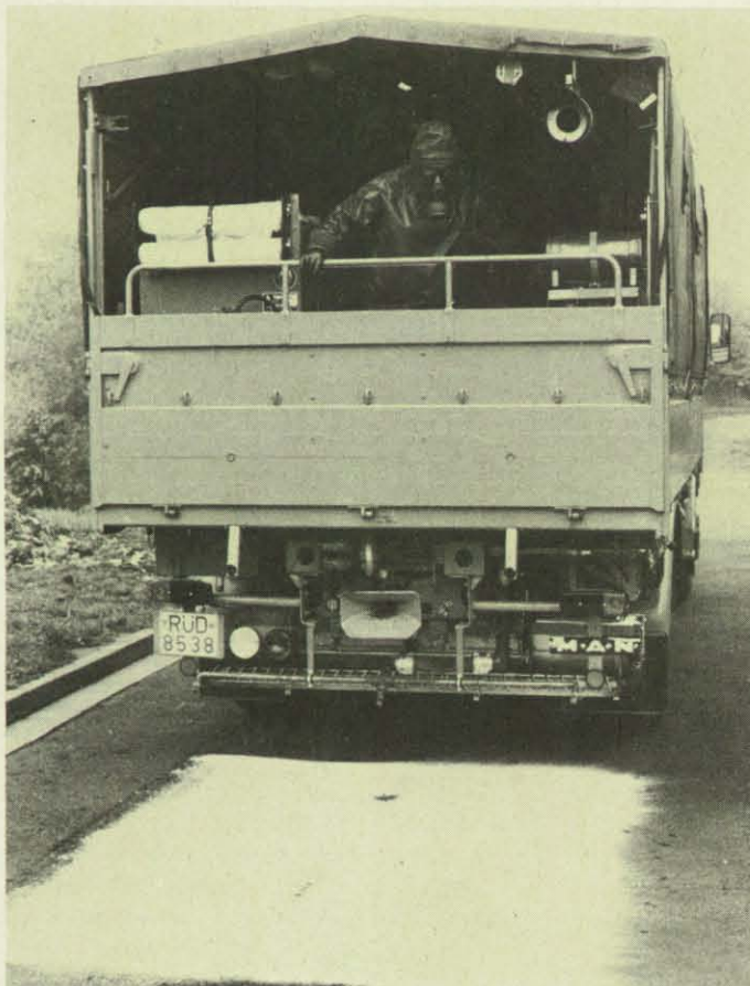
Das Dekontaminations-Mehrzweckfahrzeug (DMF) kann zur Dekontamination großer Flächen eingesetzt werden. Hier wurde eine Chemikalie zur Wirkungsbeseitigung auf ein kontaminiertes Straßenstück ausgebracht.
