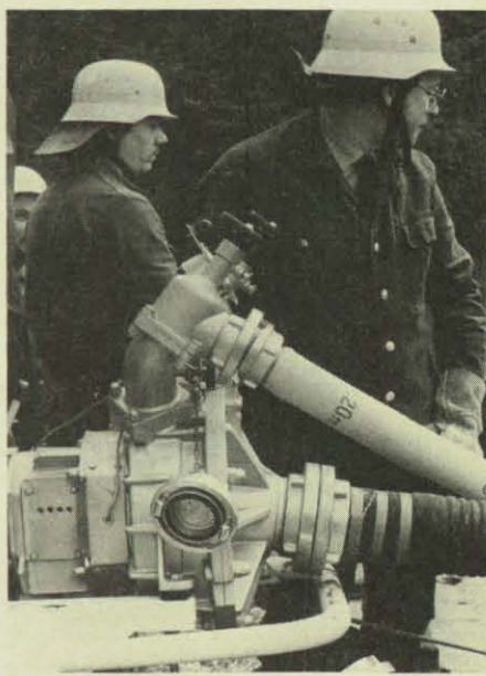
Eine Vorbaupumpe in Betrieb.
