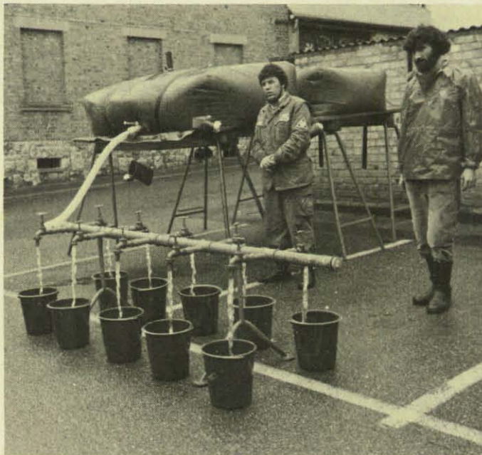
Bild 8: Verteilung von Trinkwasser über eine Gruppenzapfstelle aus transportablen Trinkwasserbehältern, stationär erhöht auf Gerüstböcken gelagert.
