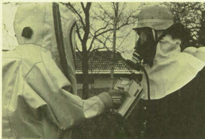
Mit dem Kontaminations-Nachweisgerät werden aus dem Gefahrenbereich kommende Einsatzkräfte auf eine eventuelle Verstrahlung hin geprüft.
