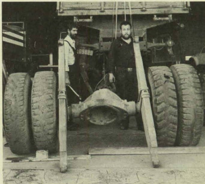
Schäden an der Hinterachse aufgrund der schlechten Straßenverhältnisse bildeten ein häufig auftretendes Schadensmerkmal.
