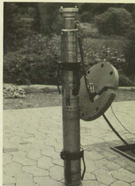
Bild 4: Trinkwasser-Notbrunnen mit stromnetzunabhängiger Energieversorgung – Unterwasserelektromotorpumpe zur Demonstration neben dem geöffneten Brunnenschacht aufgebaut.
