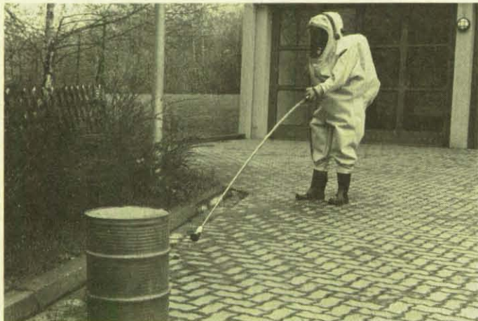
Der Teletector ermöglicht mit seinem teleskopierbaren Meßrohr eine Prüfung der Gefahrenstelle, ohne daß die Einsatzkraft durch eine zu große Annäherung stärker gefährdet wird.
