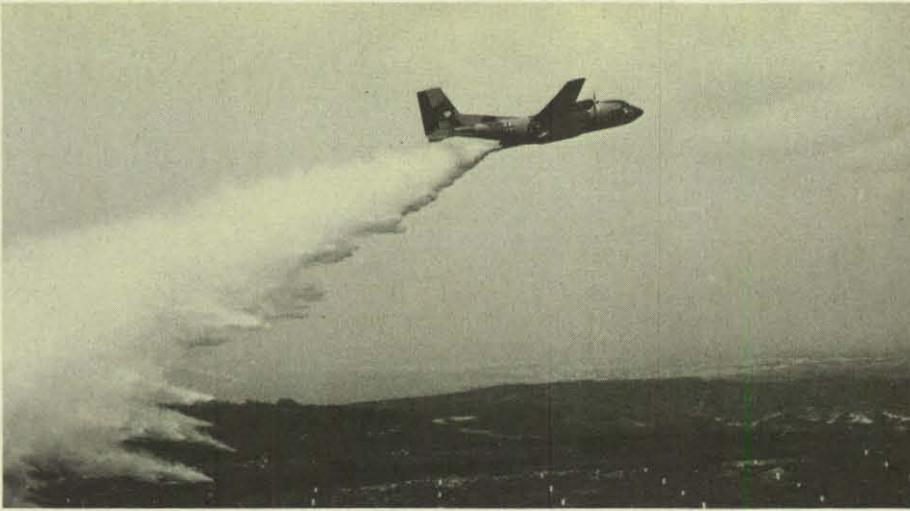
Vier bis sieben Sekunden dauert der Löschmittelabwurf aus der Transall, dann sind 12000 Liter Wasser auf die Flammen geprasselt.
