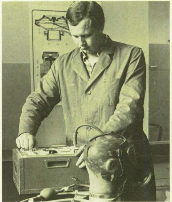
Eine Atemschutzmaske wird auf ihre Dichtigkeit überprüft.
