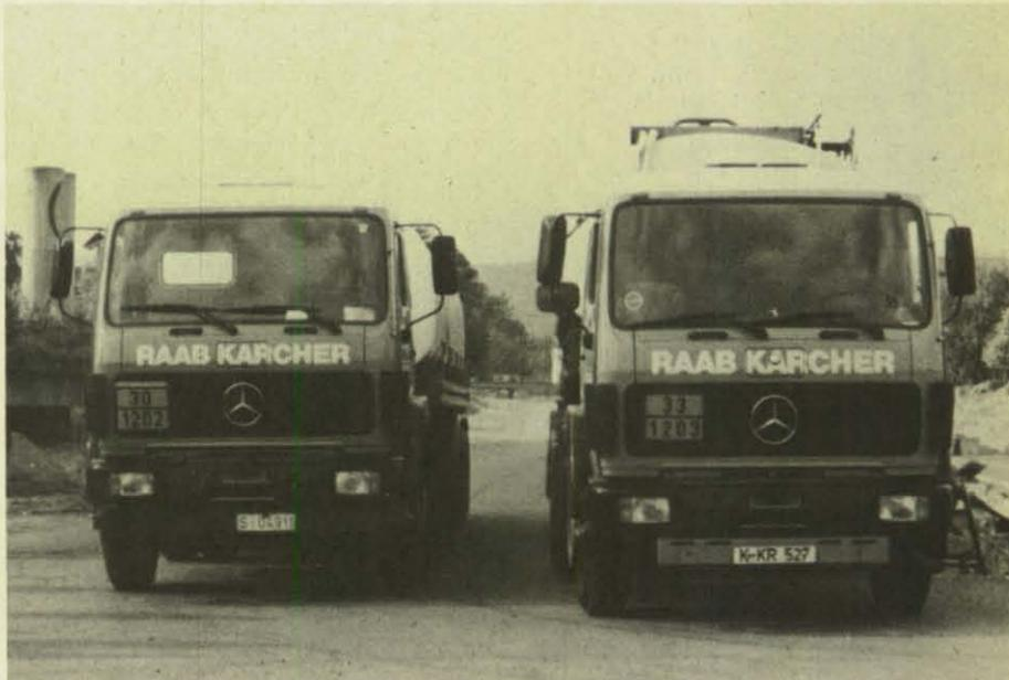
Oben: Im Vergleich der beiden Fahrzeuge ist die um 30 Zentimeter niedrigere Bauart des neuen Tankzuges (links) deutlich erkennbar.
