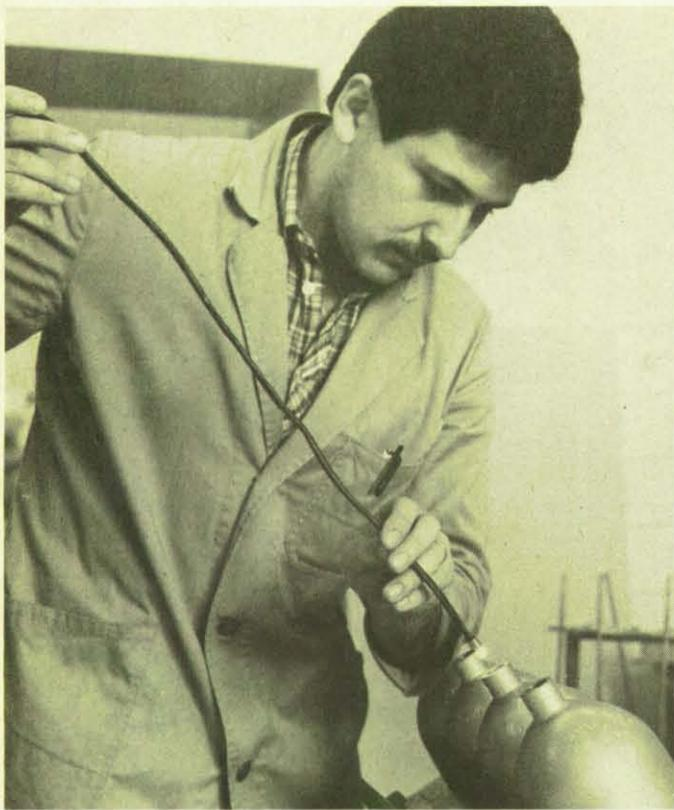
Das Innere der Preßluftflasche wird ausgeleuchtet.
