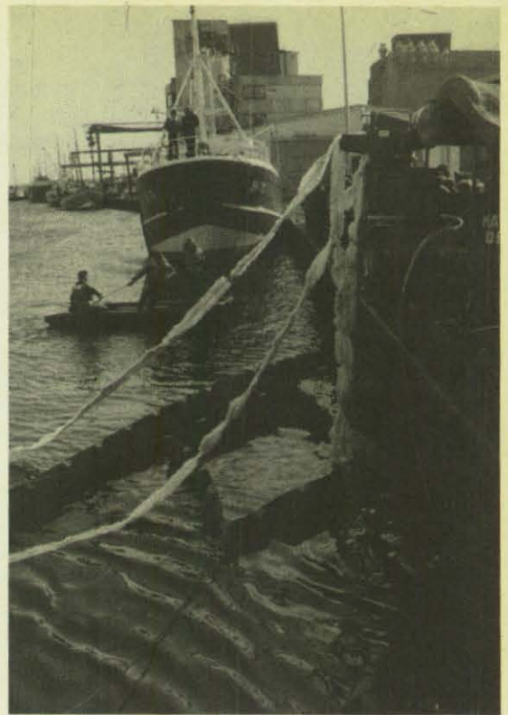
Rechts: Gleichzeitiges Arbeiten mit einer vertikalen und einer horizontalen Mopkordel. (Fotos: Behrens)
