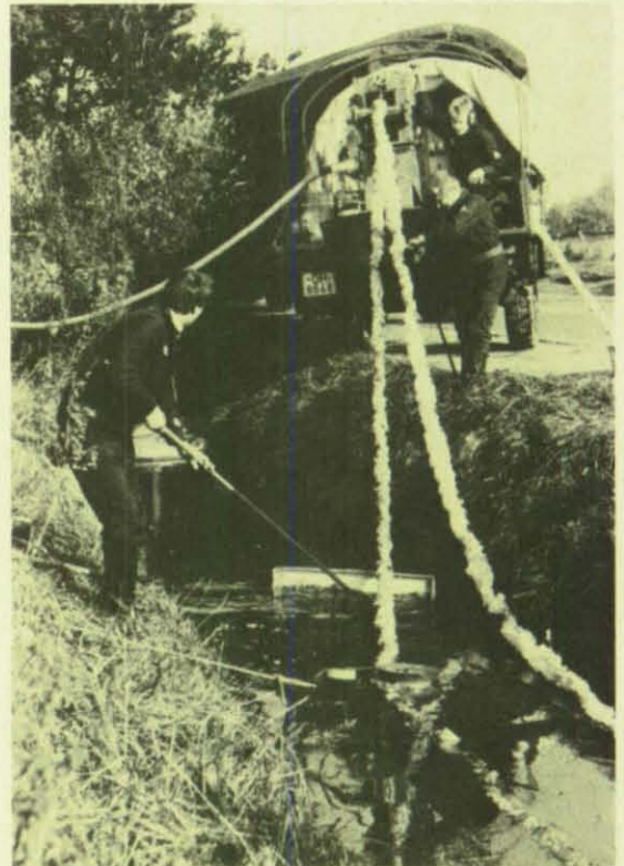
Rechts: Der Mopmatic-Wringer im Einsatz. Die Kordel wird über Umlenkrollen geführt.
