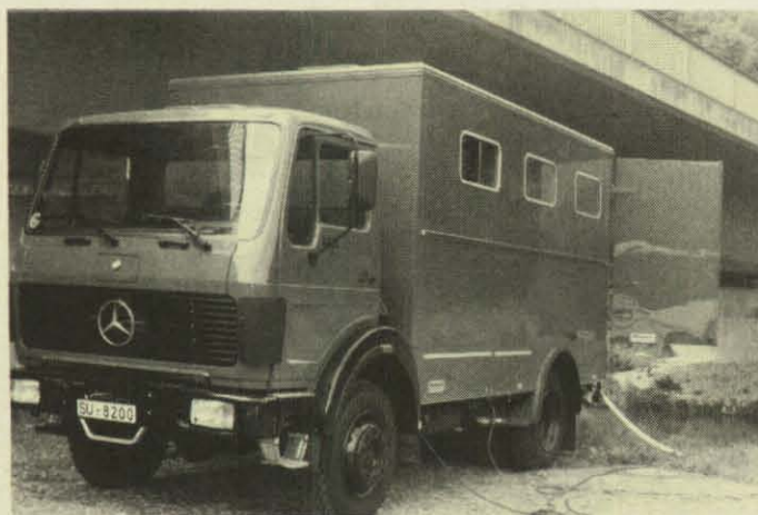
Bild 1: Außenansicht des Lastkraftwagens mit der im Kastenaufbau installierten Trinkwasser-Aufbereitungsanlage.
