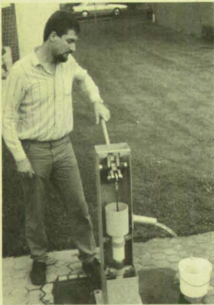
Bild 4: Innenansicht der Einfachhandpumpe mit abgenommenem Pumpengehäuseteil während der Förderung
