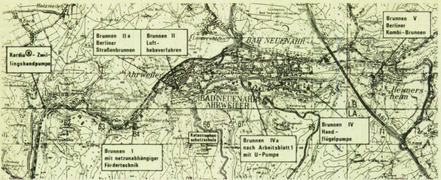
Bild 11: Zu Demonstrations- und Erprobungszwecken im Ahrtal errichtete Trinkwasser-Notbrunnen mit verschiedenartigen Fördereinrichtungen.
