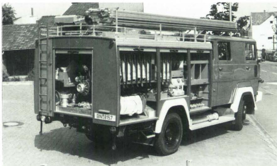
Die Fahrzeuge haben zwei angetriebene Achsen und sind mit einer Zusatzheizung sowie mit zwei Rundumkennleuchten ausgestattet.
