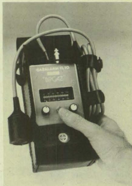
Das vorgestellte Meßgerät bietet die schnelle Meßwertanzeige mit optischem und akustischem Signal. Dieses mobile Explosimeter verfügt über zwei unabhängige Meßverstärker und kann damit auf zwei verschiedene Gase oder zwei Meßbereiche für dasselbe Gas kalibriert werden. Je nach Ausführung bietet das Gerät bis zu 40 Stunden netzunabhängige Betriebsdauer. Es ist auch mit digitaler Flüssigkristallanzeige lieferbar.
