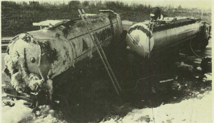
Unten: Aus dem verunglückten Tanklastzug wird das Kunstharzgemisch mit einer Spezialpumpe des THW umgefüllt. (Fotos: Behrens)
