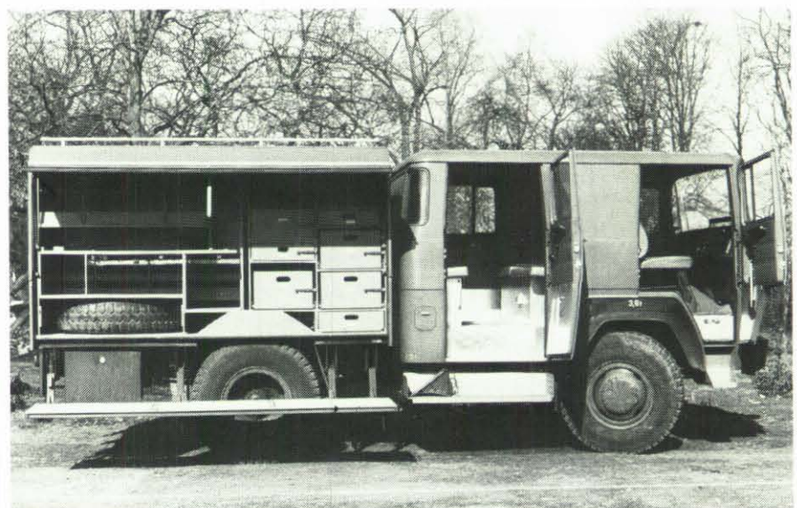
– Typ Daimler-Benz LA 911, zul. ges. Gew. 8500 kg, Diesel 95,6 kW.
