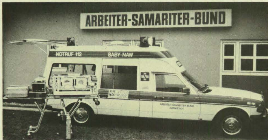
Links: Der Baby-Notarztwagen des Arbeiter-Samariter-Bundes (ASB) Darmstadt, davor der Transportintensivinkubator mit Beatmungseinheit, Perfusionspumpe und Beleuchtung (12 V), sowie EKG-Monitor und Arztkoffer auf Fern-Untergestell.
