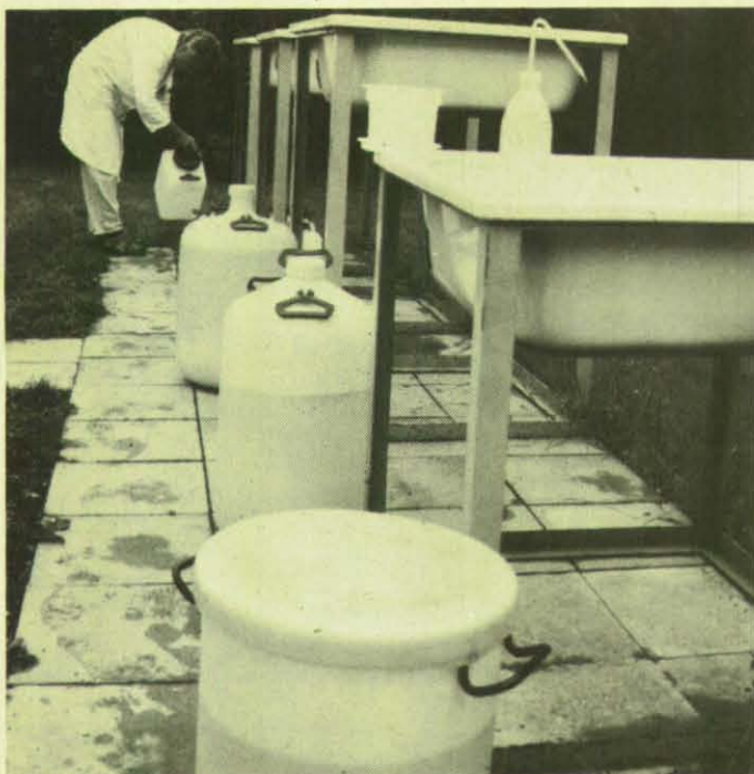
Das Auffangen von Niederschlägen ist bei einigen Radionukliden die einzige Möglichkeit, sie sicher zu identifizieren.
