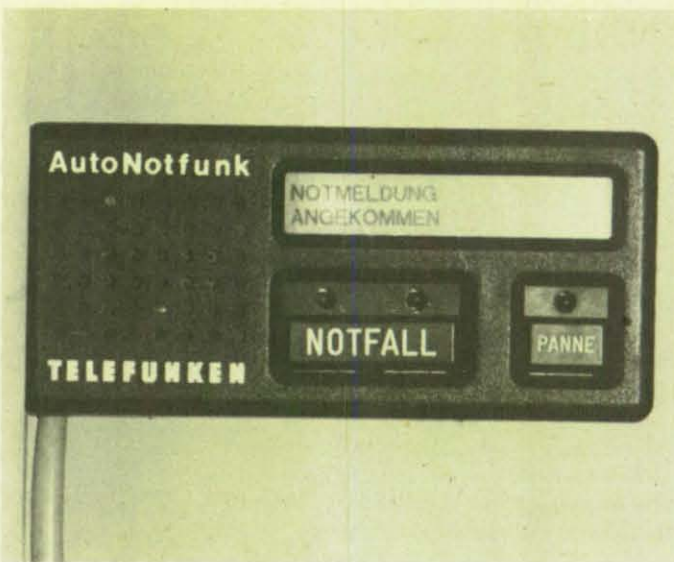
Rechts: Das drahtlose Notmeldesystem „Auto-notfunk“.
