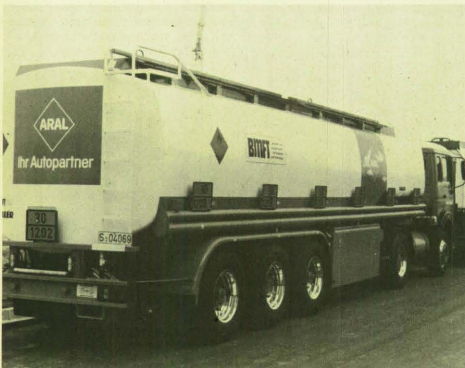
Die orangefarbenen Warntafeln, hier an einem vom Bundesminister für Forschung und Technologie geförderten neuentwickelten Sicherheits-Satteltankzug, ermöglichen eine schnelle Identifizierung des Gefahrgutes.
