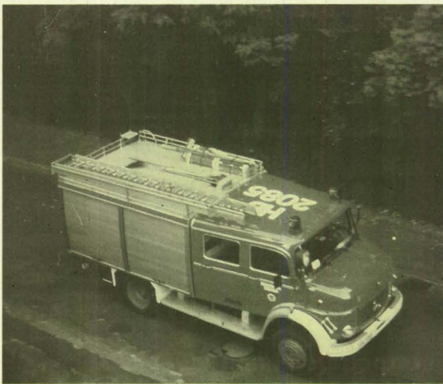
TLF 16 der Hansestadt Bremen. Fahrzeug Daimler-Benz Typ 1113 mit Metz-Aufbauten, Staffelsatzung.
