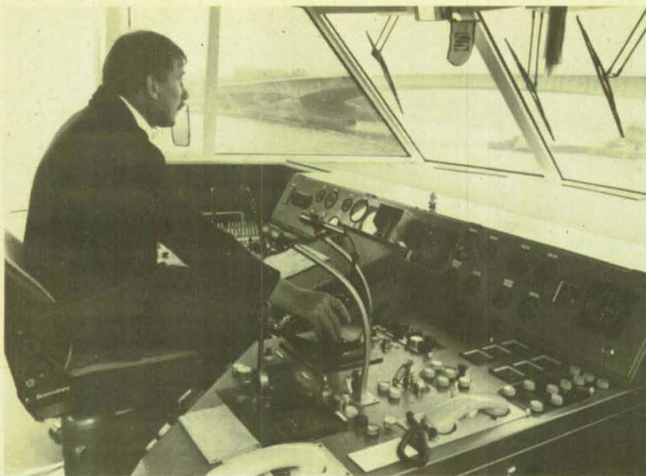
Oben: Das Steuerhaus mit Fahrpult der Drachenfels. Von hier können alle drei „Alarmrollen“ ausgelöst werden. Unten: Natürlich fehlt auf dem Schiff nicht der klassische Rettungsring.
