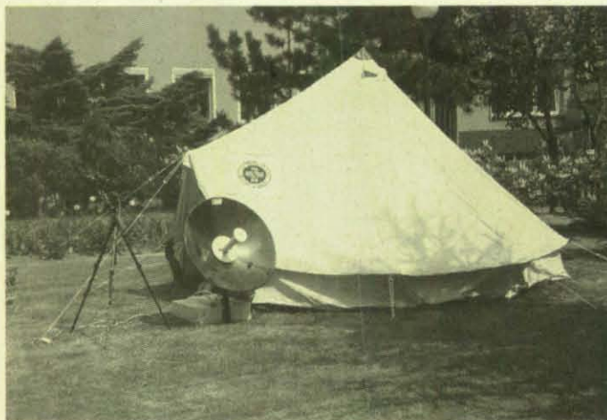
Innerhalb einer Stunde ist die Funkstation aufgebaut. Schutz bietet ein kleines Zelt. Der Parabolspiegel wird auf den nächstgelegenen Satelliten ausgerichtet.
