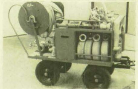
Auf einem in Eigenbau erstellten Hydrantenfahrzeug ist alles Gerät für einen Schnellangriff verstaут.
