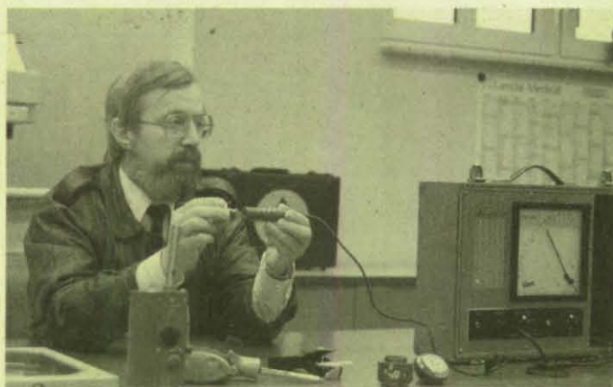
Willy Roth demonstriert Cäsium-Prüfstrahler.
