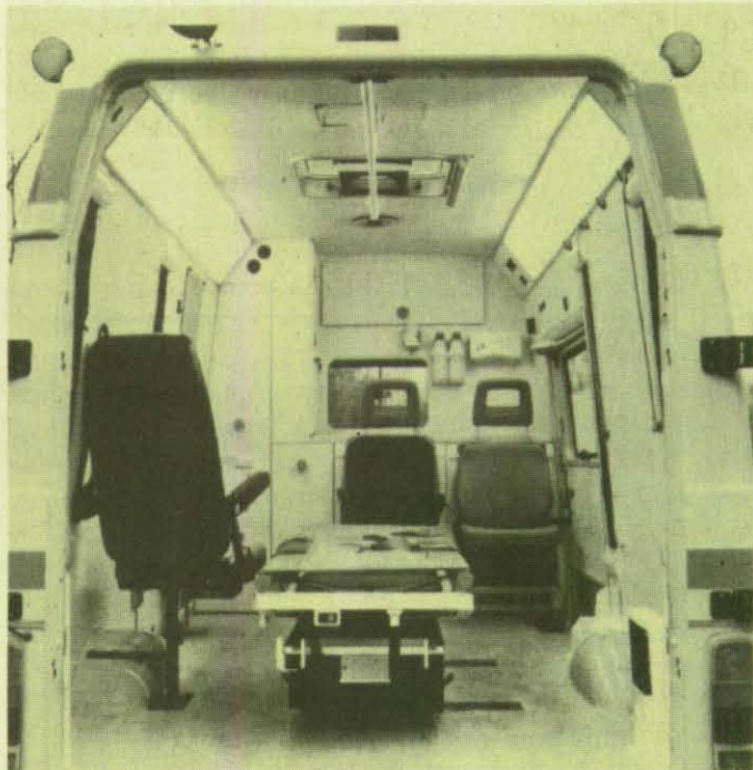
Blick in den Innenraum: Der verstell- und seitlich verschiebbare Tragentisch.
