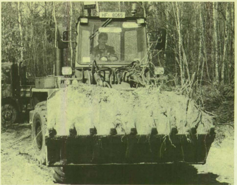
Die Schaufel in Transportstellung. Sie ist optimal gefüllt.
