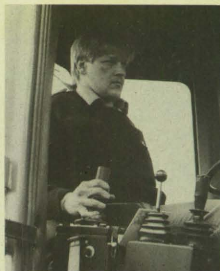
Feinfühlig muß der Servoschalter am Baggerkasten bedient werden.
