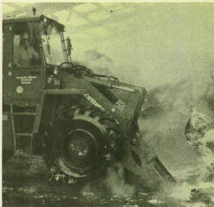
Mit dem Radlader werden die schwelenden Papierballen auseinandergezogen. (Foto: Grunig)
