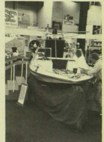
Das Rettungsboot des ASB Berlin hat statt einer Schiffsschraube einen Jet-Strahl-Antrieb.
