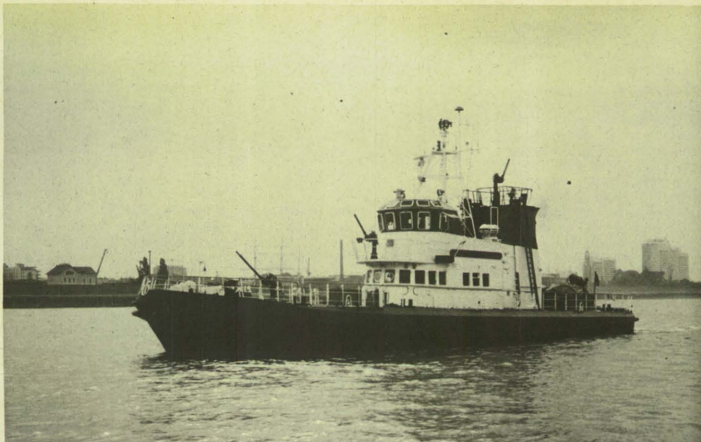
Drei Monitore mit einer Wurfweite von 90 m und einer Wasserlieferung von 3 000 l/min bietet der Löschkreuzer.
