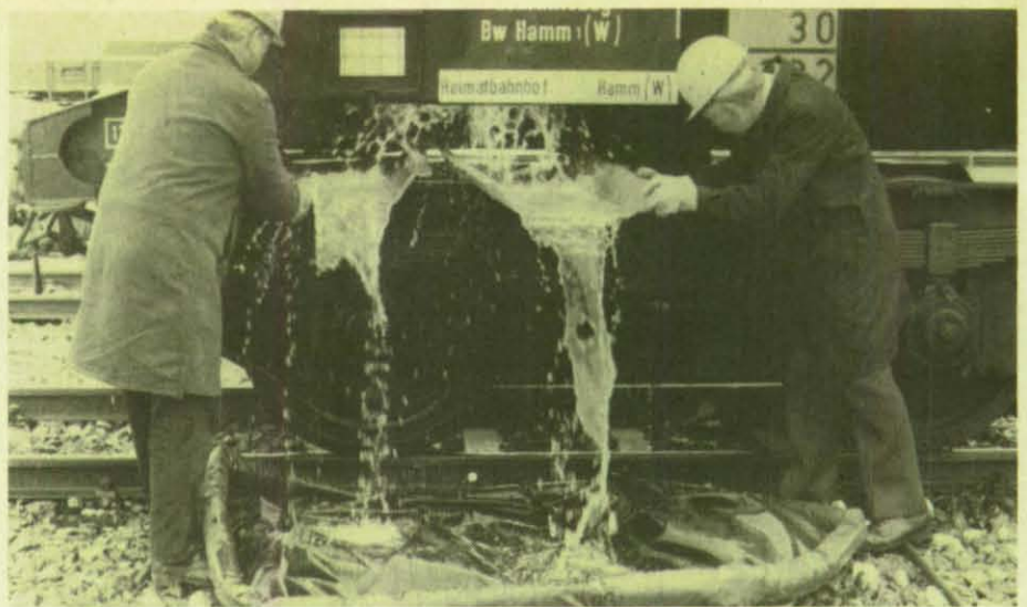
Ist die Leckstelle schlecht zugänglich, sind Leitbleche nützlich zum Abfangen der Flüssigkeit.
