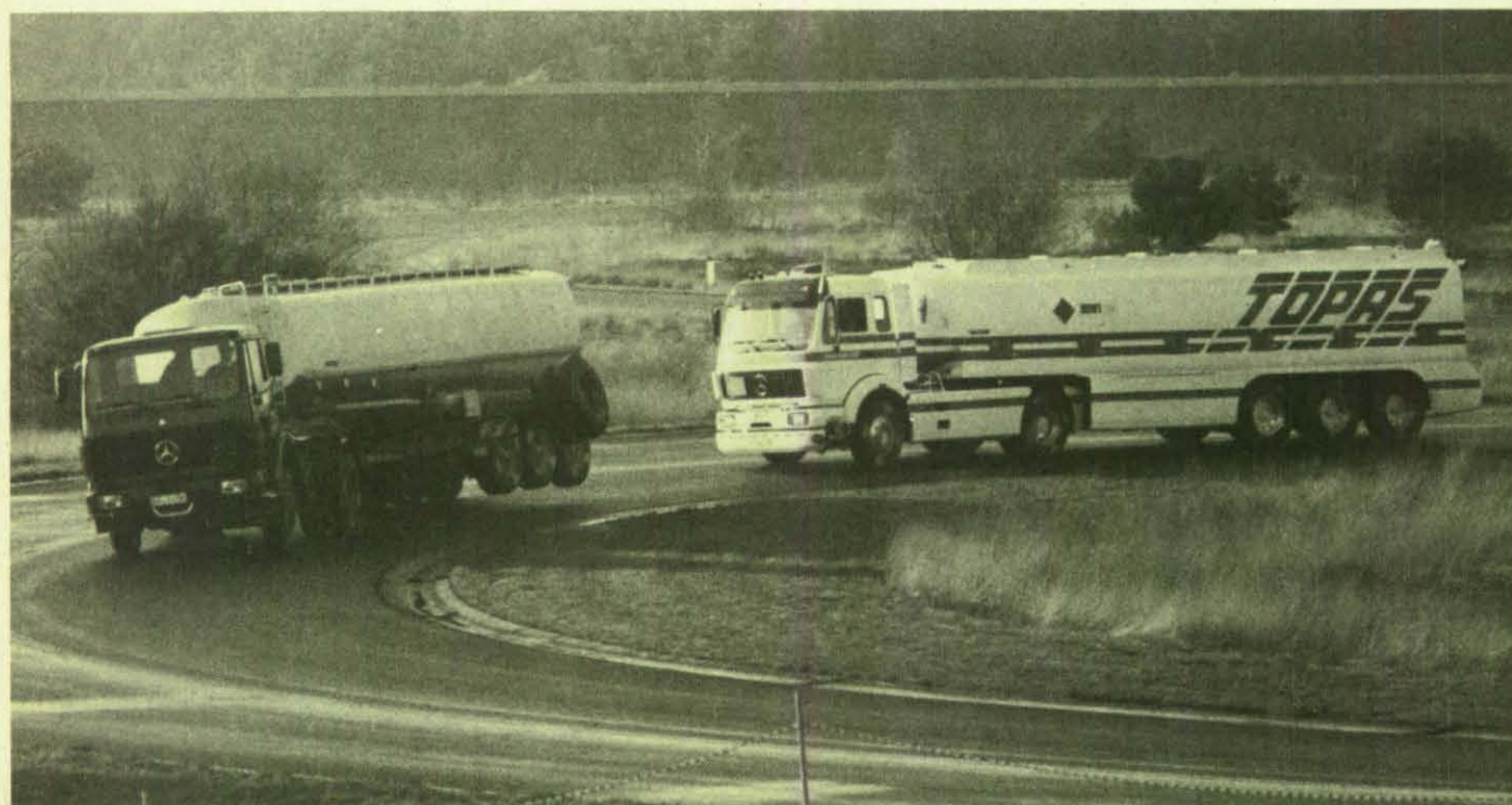
Beim Fahrversuch auf der Kreisbahn macht sich der tiefere Schwerpunkt vom TOPAS bemerkbar: Das Fahrzeug konventioneller Bauart (vorn) wäre ohne die seitlichen Stützräder nicht vor einem Umstürzen zu bewahren, während TOPAS sicher auf der Straße bleibt. (Fotos und Grafiken: Daimler-Benz AG)
