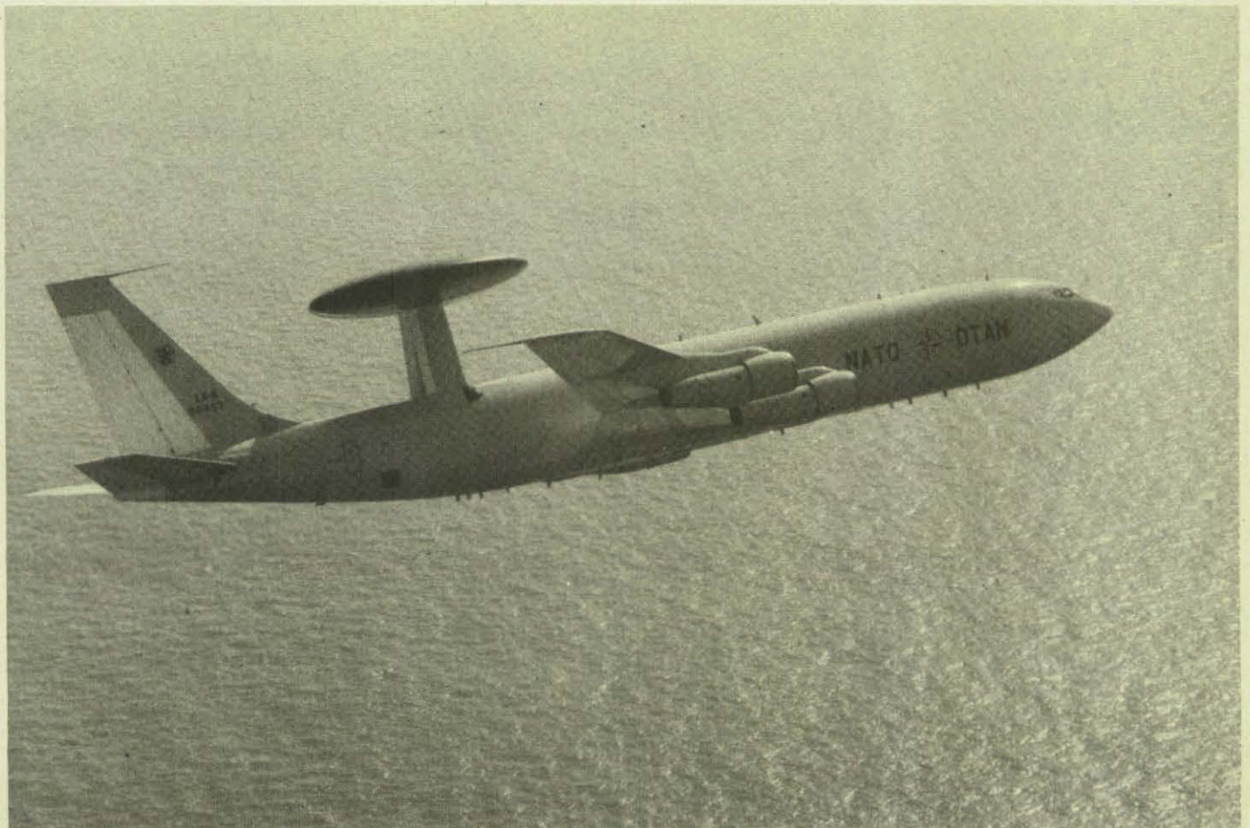
Die Flugzeuge des NATO-Frühwarnsystems AWACS (Airborne Warning and Control System) sind ein Eckpfeiler der Luftraumüberwachung.
