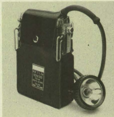
Ex-Arbeits- und Inspektionsleuchte für die Zone 1, mit wartungsfreier und aufladbarer Batterie, Ladegerät in der Leuchte integriert, Zweiwendelglühlampe für Stark- und Abblendlicht. Dieser Typ eignet sich besonders dann, wenn der Träger beide Hände frei haben muß, der Leuchtenkopf wird vorwiegend am Schutzhelm befestigt, Licht fällt deshalb immer in Blickrichtung.
