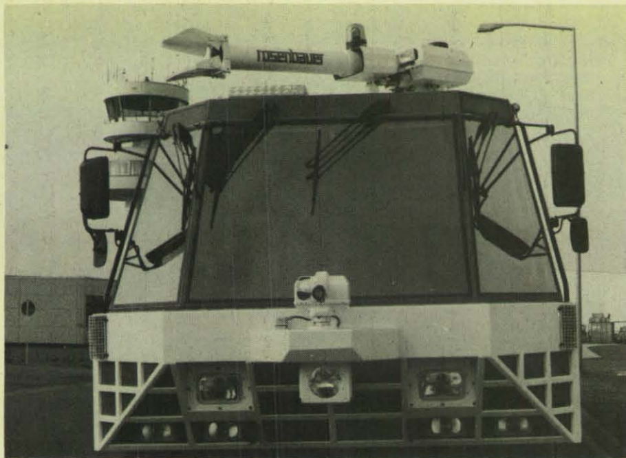
Eine Batterie von Lampen sorgt für gute Sicht; unter dem Frontmonitor ein 700-Watt-Scheinwerfer, wie er bei Flugzeugen als Landescheinwerfer Verwendung findet.
