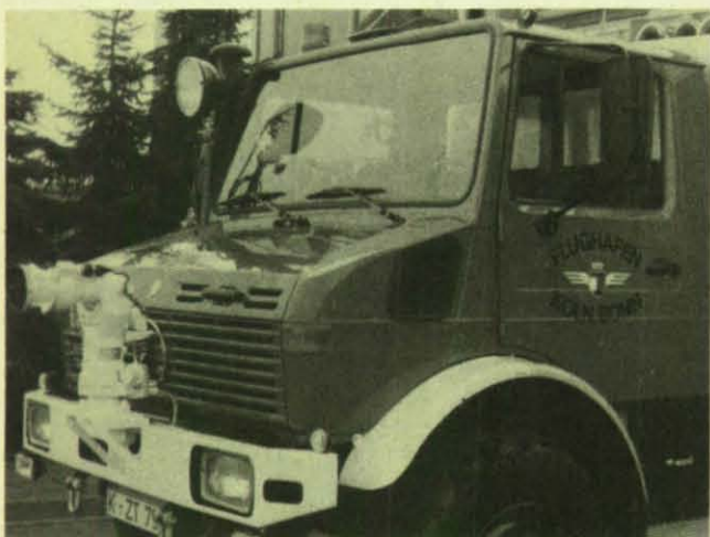
Das neue TLF 8/18 mit Frontmonitor ist eine einmalige Sonderanfertigung für den Köln/Bonner Airport.
